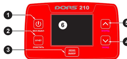
1. Кнопка «**ВКЛ / ВЫКЛ**» – включение / выключение детектора.
